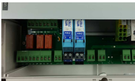
Abb. 2 Stück Zenerbarrieren in 1-Pumpen - ohne Trennplatte -
